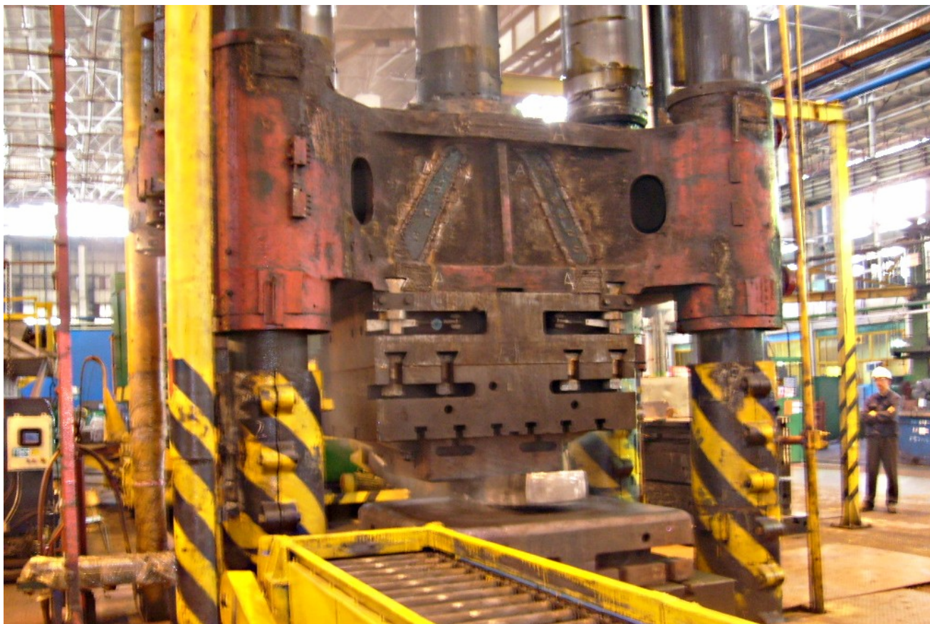
Рис. 10. Ковочный пресс силой 32 МН с восстановленной подвижной поперечиной в работе
