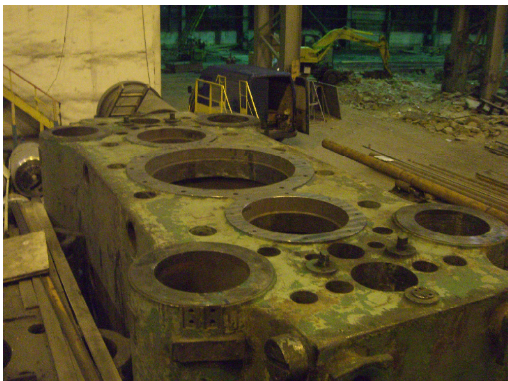
Рис. 6. Восстановление поверхностей архитрава пресса силой 60 МН в зонах контакта с гайками колонн и фланцами рабочих цилиндров: а – рабочий момент обработки контактной поверхности под фланец среднего цилиндра; б – архитрав с восстановленными контактными поверхностями под гайки колонн и фланцы цилиндров
