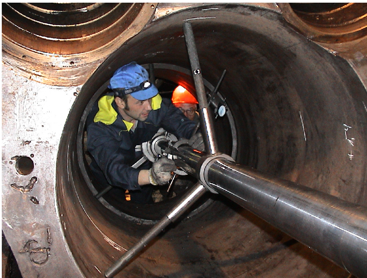
Рис. 13. Центровка расточно-наплавочной установки по базовой поверхности
