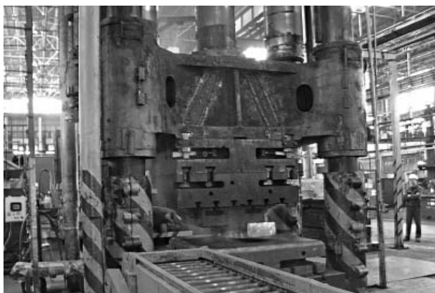
Рис. 7. Ковочный пресс силой 32 МН с восстановленной подвижной поперечиной в работе
