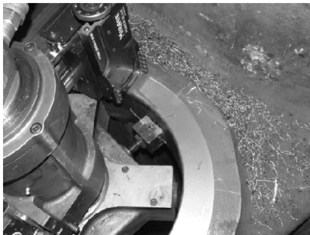
Рис. 8. Планировка контактных поверхностей стыка «поперечина-гайка-колонна» гидравлического прессы мобильным оборудованием
