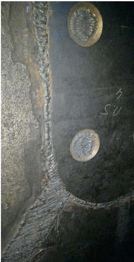
Рис. 6. Заваренная трещина и концентратор напряжений (технологическое окно)
