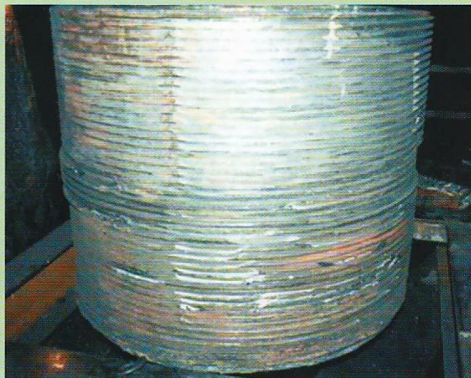
Рис. 3. Разрушение внешней резьбы колонны под основанием пресса усилием 100 МН для изготовления ж/д колес. Диаметр колонн 830 мм
