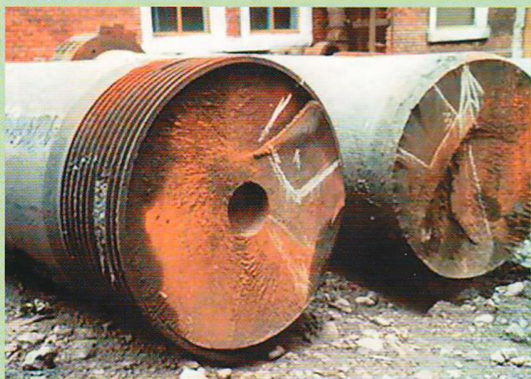
Рис. 2. Поверхности излома разрушенных колонн пресса усилием 70 МН для изготовления ж/д колес. Диаметр колонн 600 мм
