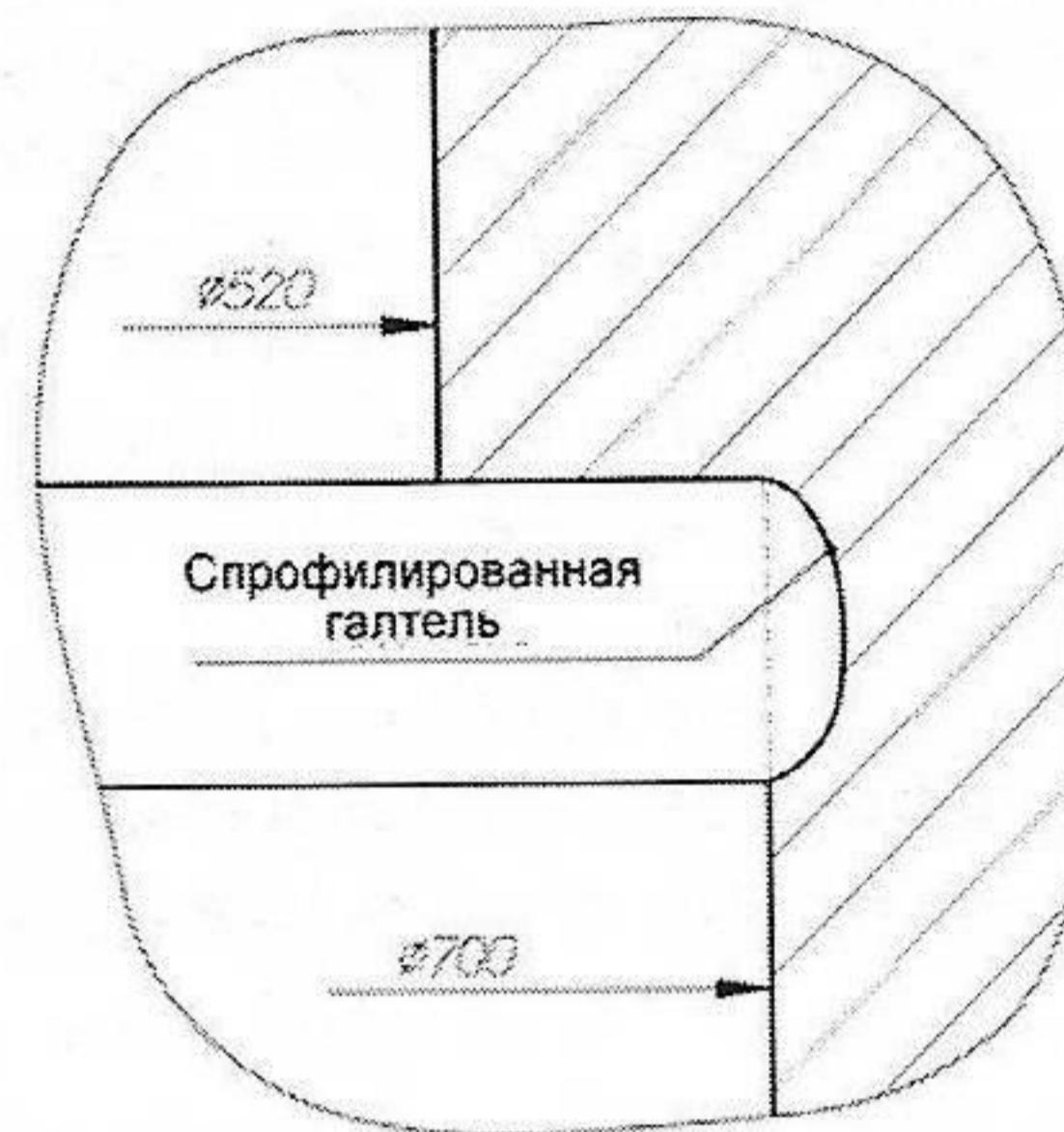
Рис. 9. Галтель с поднутрением стенки для верхней поперечины станины клети № 2 стана 1700 ОАО «Северсталь»
